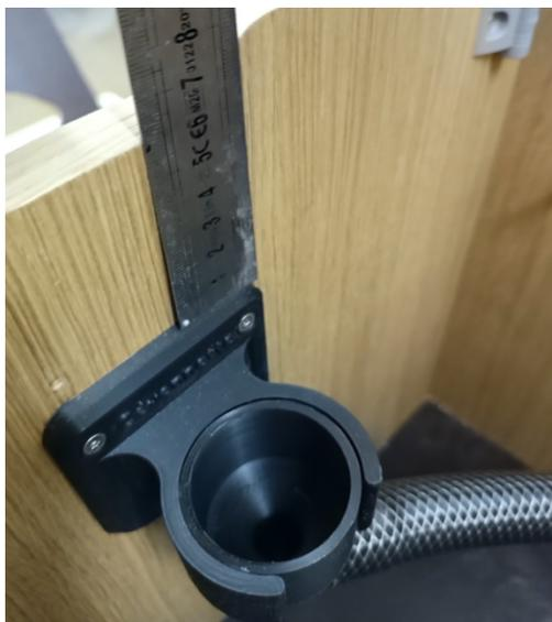
Le « bec » du séparateur doit pénétrer d'au moins 10 mm dans le collecteur, idéalement en son centre et la platine doit donc être fixée dans l'axe du séparateur.
